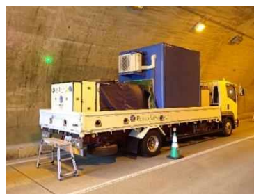
トンネル点検(レーザー打音)
